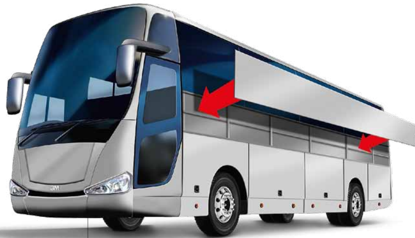
Verklebung von Karosserie-Anbauteilen
